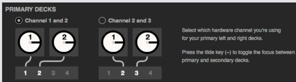
Verwenden Sie die Tilde-Taste (~), um den Fokus zwischen primären und sekundären Decks zu wechseln.
