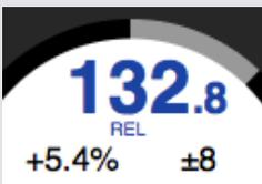
Wenn ein Deck in Sync ist, beeinflusst eine Änderung der Tonhöhe von einem Deck auch die aller anderen synchronisierten Decks. Wird Sync auf einem Deck deaktiviert, bleibt die Tonhöhe im relativen Pitch-Modus. Die relative Tonhöhe reagiert auf Bewegungen der Schieberposition nach oben oder unten, aber nicht unbedingt die absolute Position auf dem Schieberegler der Hardware. Um den Schieberegler auf absolute Tonhöhe zurückzusetzen, können Sie entweder
