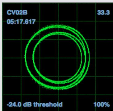
Die Bereiche auf dem Setup-Bildschirm in Serato DJ zeigen das Eingangssignal als Phasendiagramm an. Die wichtigsten Faktoren auf der Bereichsanzeige sind klare Linien, runde Formen und der Tracking-Anteil in der rechten unteren Ecke.
