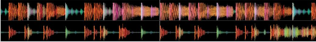
Dieser Bereich bietet eine detaillierte Übersicht über den Titel, einschließlich Farbcodierung zur Anzeige der Klangfrequenzen; Rot steht für Basstöne mit niedriger Frequenz, Grün für mittlere Frequenz und Blau für hohe Frequenz. Sie können auch zu einer Drei-Band-Ansicht wechseln, indem Sie die Strg-Taste drücken und auf die Wavform klicken.
