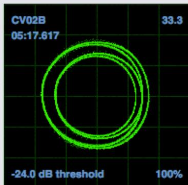
Les zones de l'écran de configuration dans Serato DJ affichent le signal d'entrée sous forme de diagramme de phase. Les principaux facteurs à vérifier dans la vue d'oscilloscope sont des lignes bien nettes, une forme ronde et un pourcentage de suivi au coin inférieur droit.
