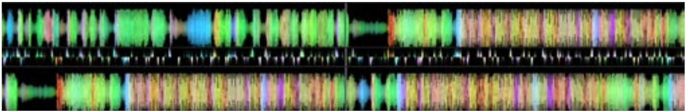
Cette zone fournit une vue rapprochée de la piste, en utilisant un code couleur pour la fréquence du son : le rouge représente les sons graves basse fréquence, le vert représente les sons moyenne fréquence et le bleu représente les sons aigus haute fréquence.
